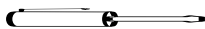
Destornillador plano pequeño (2 a 2.4 mm o 3/32" de tamaño de punta, 60 mm de largo)
