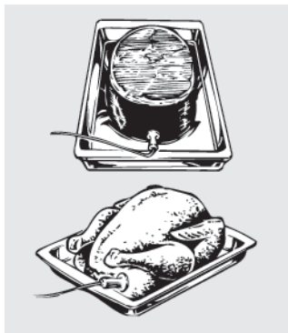
La sonda de temperatura tiene una sonda parecida a una brocheta en uno de sus extremos y una clavija en el otro extremo que se conecta en el contacto que se encuentra dentro del horno.
